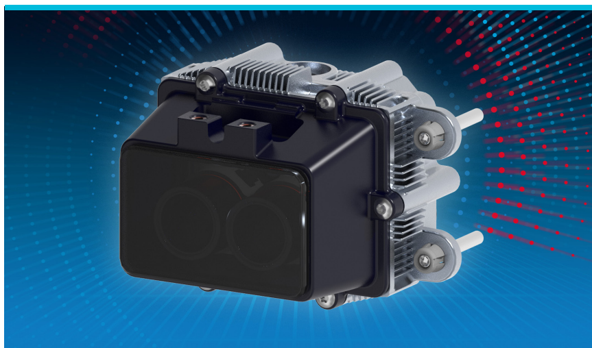
Rys. 16. ZF produkuje półprzewodnikowy system lidarowy „ibeoNEXT” wraz z jednostką sterującą (w imieniu Ibeo Automotive Systems GmbH) i rozpoczął dostawy tego produktu w październiku 2020 r. Czujnik lidarowy oparty jest na technologii pomiaru lasera fotonowego i nie ma ruchomych części (półprzewodnik). (Rysunek: zdjęcie prasowe ZF Friedrichshafen AG)
